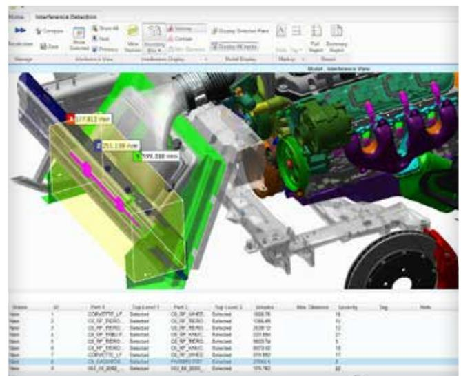
Erkennung und Analyse von Kollisionsproblemen mit dem optionalen Modul Creo View Interference Analysis
